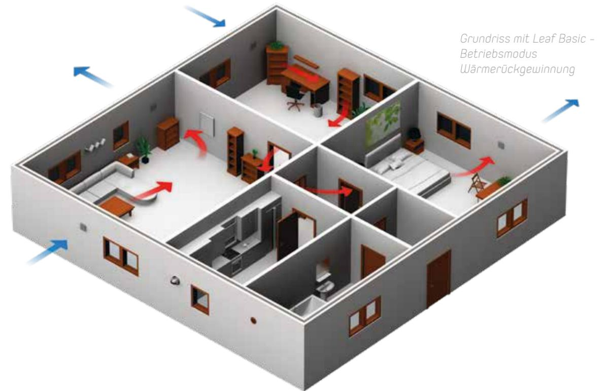
Grundriss mit Leaf Basic - Betriebsmodus Wärmerückgewinnung
